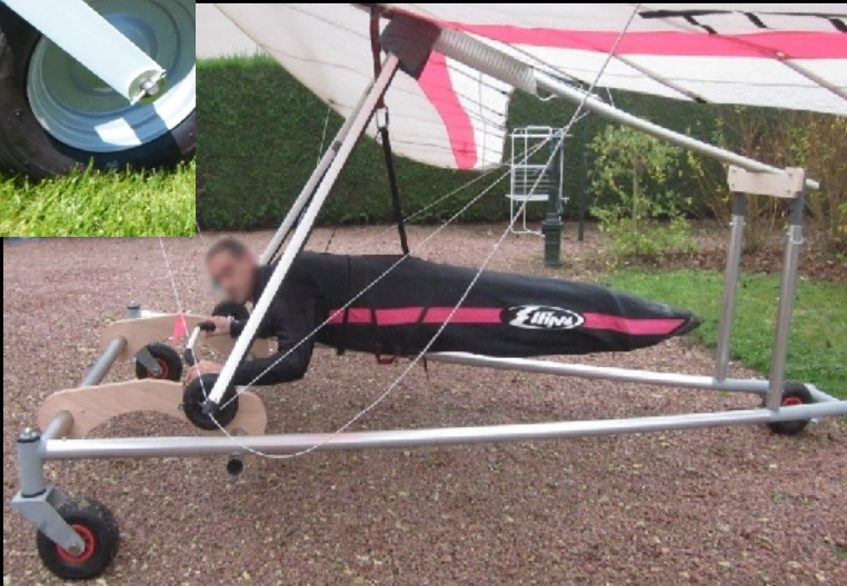
déport des roues avant, avec chasse importante, support de quille adaptée aux stab de queue.
