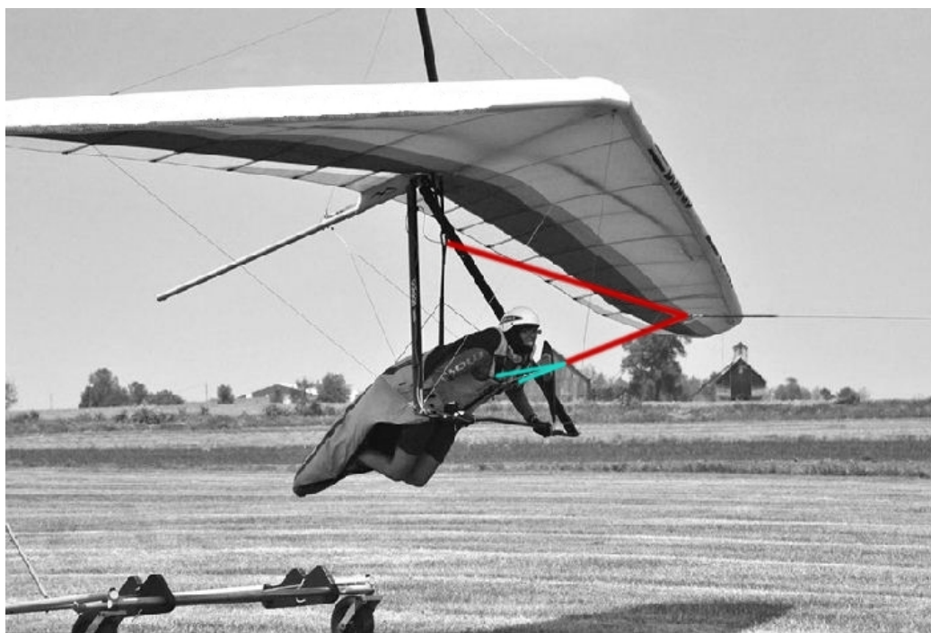
Traction en 2 points 1:1 – ici, le point d'ancrage est au mousqueton
